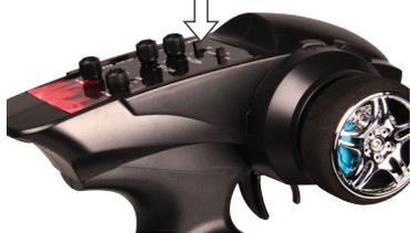
Mit dem Servowegumkehrschalter für den ersten Kanal (CH1) wird die Drehrichtung des Lenkservos umgekehrt.
